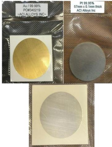
Figura 2.32 Blancos metálicos para contactos eléctricos de Plata, Platino y Oro.
