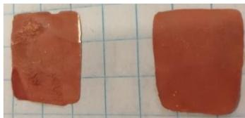
Figura 2.9 Láminas de cobre adelgazadas.
