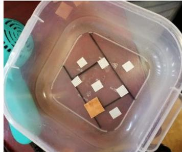
Figura 2.6 Montaje de láminas en recipiente del sistema de bamboleo.
