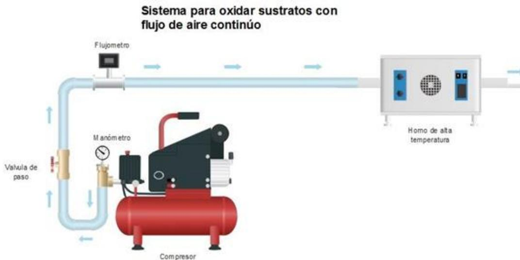
Figura 2.20 Sistema de oxidación con flujo de aire. Se puede observar el compresor de aire. Una vez finalizado el lapso de 24 horas sin interrumpir el proceso de oxidación, se apagó el horno y se mantuvo el flujo de aire, dejando enfriar las muestras hasta llegar a temperatura ambiente.
