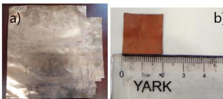
Figura 2.4 a) Placa de cobre comercial usada para la fabricación de los sustratos b) Lamina dimensionada previo al adelgazamiento.
