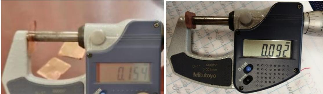
Figura 2.8 Espesores obtenidos después del proceso de adelgazamiento.
