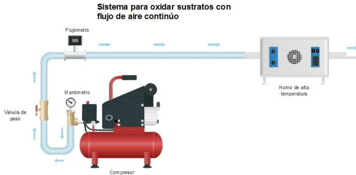
Figura 2.14 Esquema del sistema de oxidación con flujo de aire.
