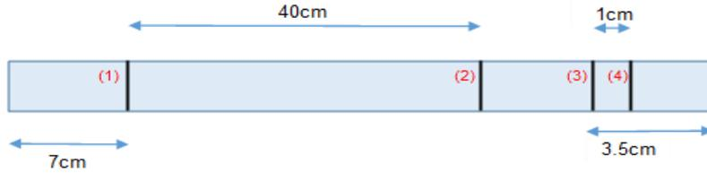
Figura 2.22. Vista de la sección transversal del tubo de cuarzo donde se observan las marcas para montaje de los blancos y de los sustratos.
