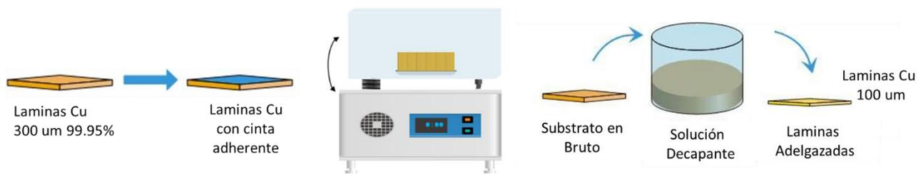
Figura 2.5 Diagrama del proceso de adelgazamiento de láminas de cobre.
