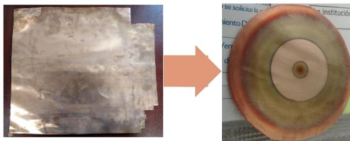
Figura 2.16 Construcción de blanco de Cu para equipo de pulverización catódica
